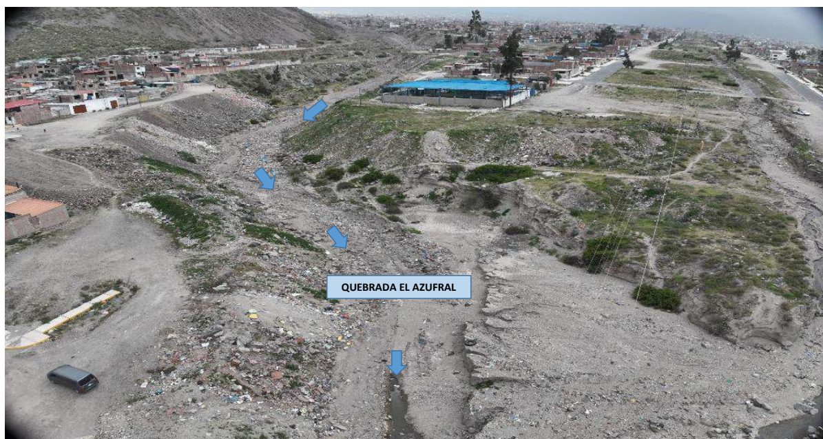
IMAGEN 03: EN ESTE TRAMO, A TRAVÉS DE LA VISTA DE DRON, SE OBSERVA LA TRAYECTORIA DE LA QUEBRADA EL AZUFRAL; Y VIVIENDAS CERCANAS A LA QUEBRADA, QUE SE ENCUENTRAN SIN PROTECCIÓN, Y SU CAUCE SE ENCUENTRA COLMATADO.
